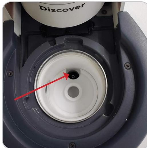
2. 將裝有反應混合物和攪拌子的圓底燒瓶放入爐腔中。
